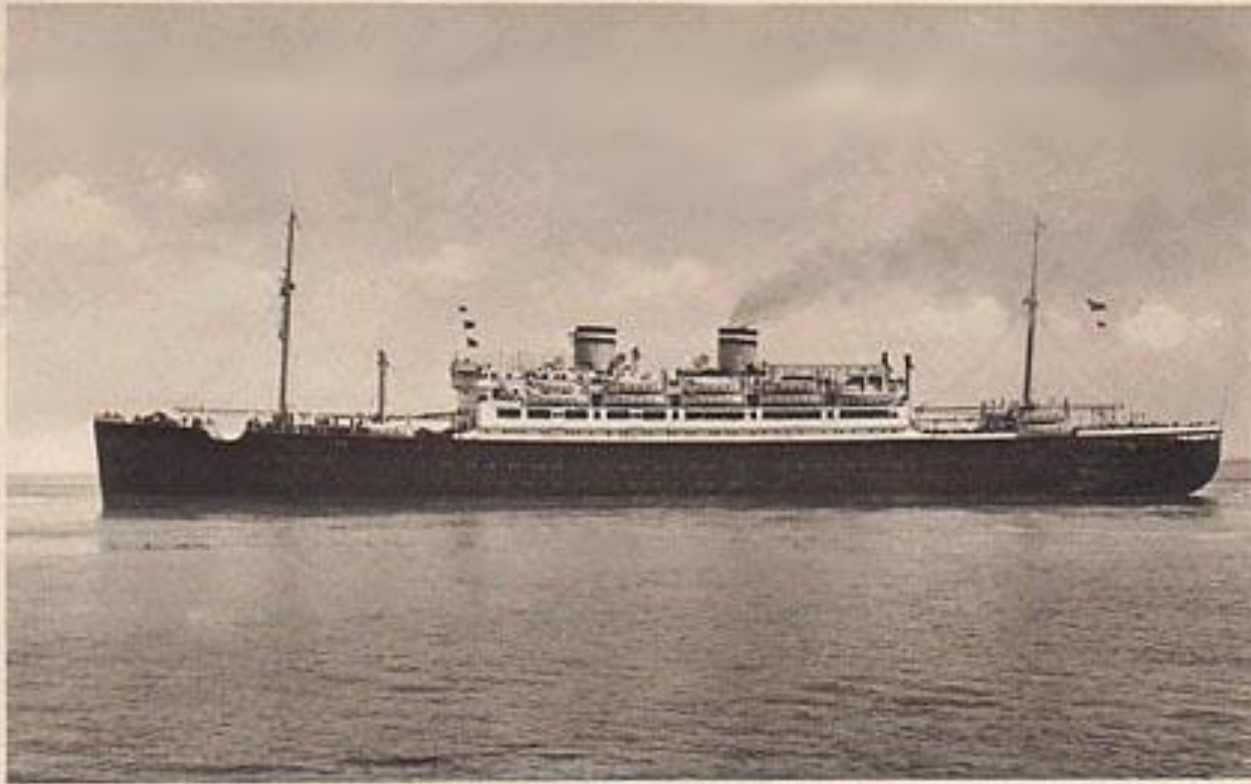
DOPPELSCHRAUBEN - MOTORSCHIFF »ST. LOUIS«. Raumgehalt: 16.732 Brutto-Registertons, Länge: 175m, Breite: 22m. Maschinenleistung: 12.000 P. S.
